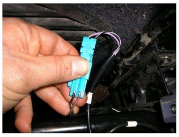
Renault préconise de souder les fils, moi j'ai préféré d'abord utiliser des cosses et si ce système ne s'avère pas efficace, je souderai ces fils finalement...
