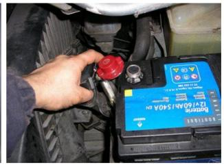
Débranchez ensuite la prise qui pose problème au niveau des connections et déclipsez l'autre
