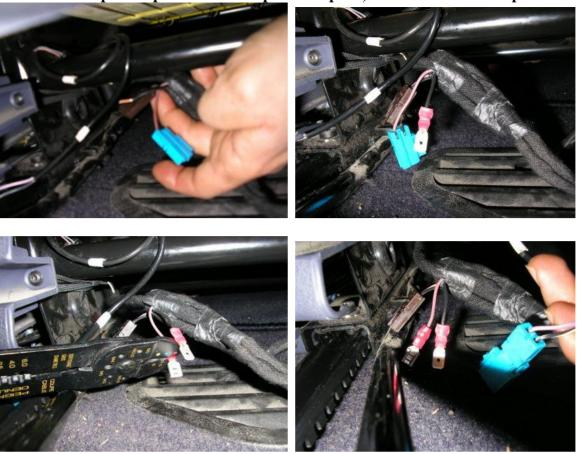
Au final, voilà le résultat, j'ai ensuite mis de la gaine thermo-rétractable et isolé avec de l'adhésif...
